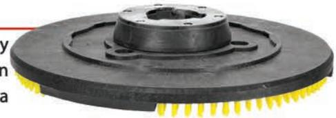
Base ahulada para sujetar discos abrasivos. Su diseño y fibras de polipropileno de 1.91 cm de longitud brindan soporte completo al disco y la tracción necesaria para su buen desempeño. Perfectamente balanceado para evitar la fatiga y vibraciones. Sistema de flujo de líquidos y herraje estándar de fibra de vidrio reforzado con nylon. Incluye alza.
