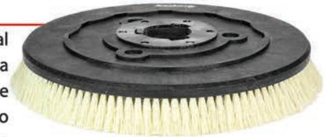
Block de plástico estructural, fabricado con fibra natural de lechuguilla de 5.08 cm de longitud. Balanceado para evitar la fatiga y vibraciones. Sistema de flujo de líquidos y herraje estándar de fibra de vidrio reforzado con nylon. Ideal para pulido de pisos duros con pasta o para el abrillantado de pisos en general. Resistente al contacto con ácidos.
